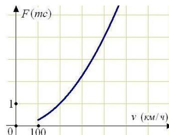
для некоторого самолета. На оси абсцисс откладывается скорость (в километрах в час), на оси ординат – сила (в тоннах силы). В некоторый момент подъемная сила равнялась одной тонне силы. Определите по рисунку, на сколько километров в час надо увеличить скорость, чтобы подъемная сила увеличилась до 4 тонн силы?
