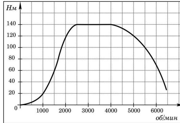
8. На графике изображена зависимость крутящего момента двигателя от числа его оборотов в минуту. На оси абсцисс откладывается число оборотов в минуту, на оси ординат — крутящий момент в Н м. На сколько больше оборотов в минуту станет совершать двигатель при увеличении крутящего момента с 1500 Н м до 2500 Н м?
